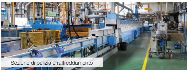
Linee di estrusione in gomma con bagno salino e vulcanizzazione UHF
