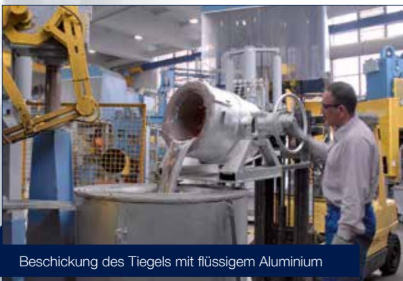
Beschickung des Tiegels mit flüssigem Aluminium
